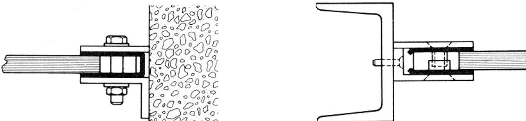
**Figure 14 — Serrage de verre trempé sous parclose métallique**
